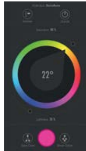
Regler für den Farblauf in %, Helligkeit und Dimmbarkeit von LED-Leisten RGB
